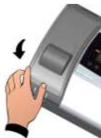
**Fig. 4 :** Ouvrir le devant du boîtier en soulevant et en faisant coulisser les deux charnières jusqu'à la butée d'arrêt.
