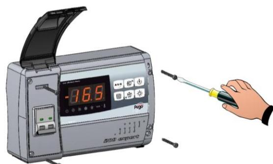
**Fig. 3 :** Fermez le couvercle transparent protégeant le disjoncteur magnétothermique différentiel.
