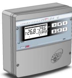
Fig. 4 : Refermez le couvercle frontal en veillant à ce que tous les câbles soient bien à l'intérieur du boîtier et que le joint de celui-ci soit bien dans son logement. Fixez le couvercle frontal à l'aide des 4 vis prévues à cet effet (réutilisez les joints toriques présents sur la gorge de chaque vis). Mettez le contrôleur sous tension et effectuez une lecture et une programmation attentives de tous les paramètres sélectionnés.
