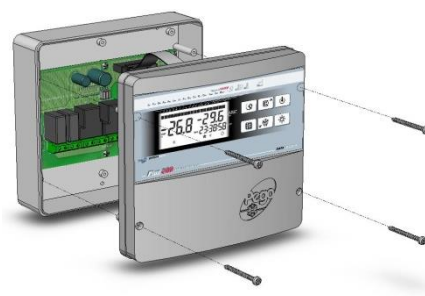
Fig. 2 : Débrancher le connecteur J2 qui relie les deux cartes de circuit avec le câble plat.
